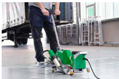
VARIANT 700 для сварки внахлёст
